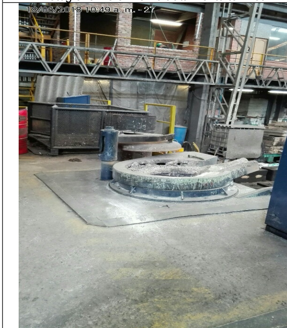
Fotografía No 5. Horno inducción 500 kg
