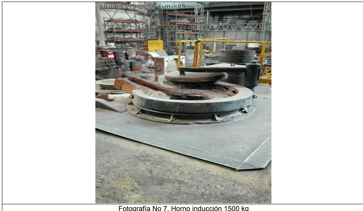
Fotografía No 7. Horno inducción 1500 kg
