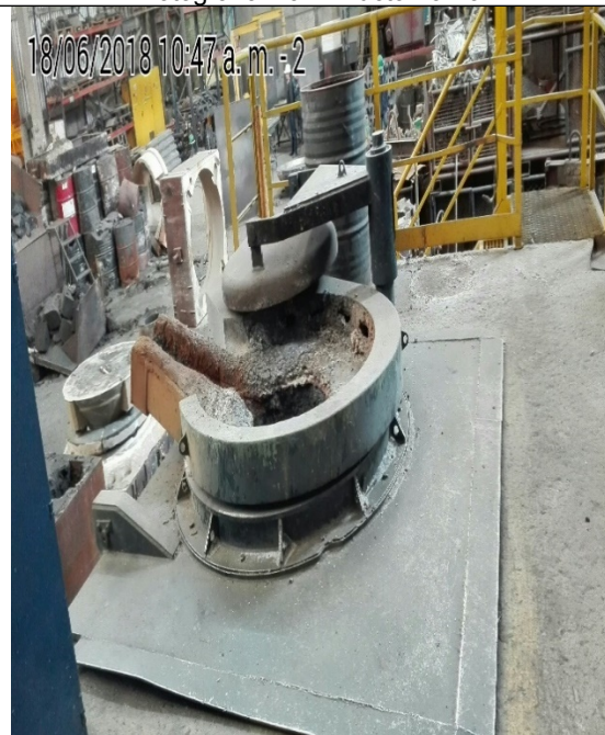
Fotografía No 6. Horno inducción 1000 kg
